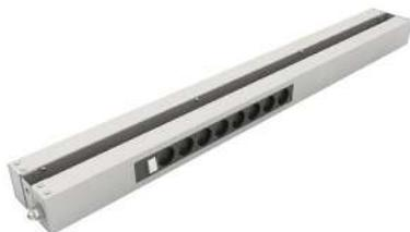
Блок электрических розеток для столов серии СМ-О двухсторонний, выполнен в металлическом корпусе, имеет по 6 розеток с контактом земли с каждой стороны, плату сетевого фильтра и предохранитель 10 А, выключатель, шнур 3 м.
