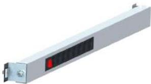
Блок электрических розеток выполнен в металлическом корпусе, имеет 6 розеток с контактом земли, плату сетевого фильтра и предохранитель 10 А, выключатель, шнур 3 м.
